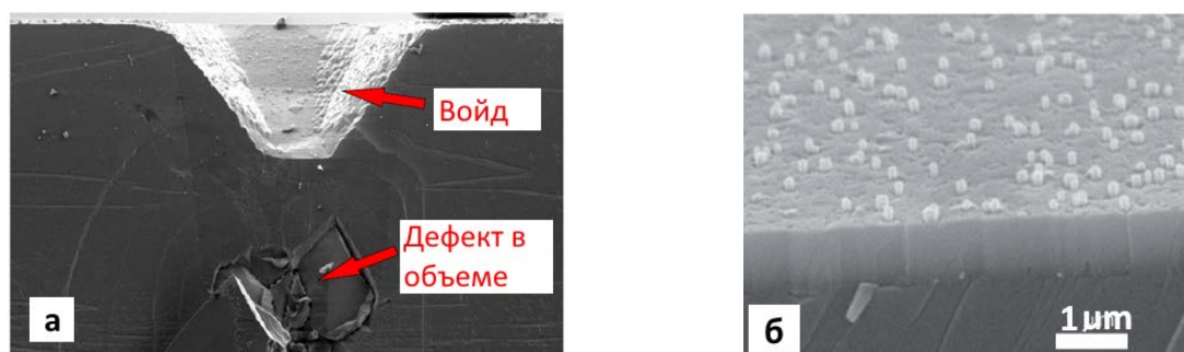
Рисунок 1.1 - СЭМ изображения дефектов и особенностей поверхности кристалла GaN: поперечное сечение войда по данным [36] (а) и нитевидные нанокристаллы GaN [37](б)
